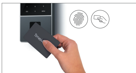
Anmelden durch Auflegen eines RFID-Ausweises, Scannen des Fingerabdrucks oder Eingabe einer PIN
