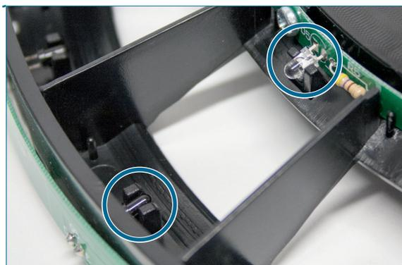
5. Nettoyez les capteurs de passage avec un coton-tige et de l'alcool.
