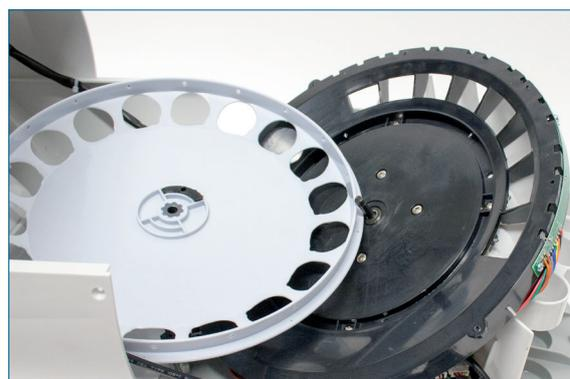
7. Nettoyez le disque et le reste du plastique avec de préférence du détergent moussant et un chiffon propre.
